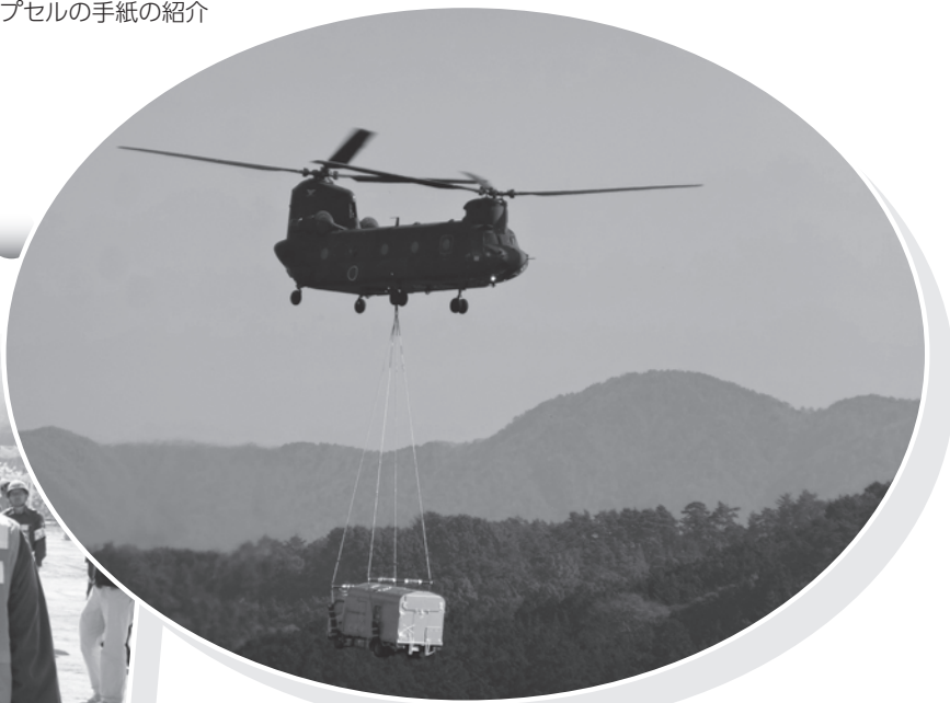
高圧電源車を搬送する自衛隊ヘリUH-47
