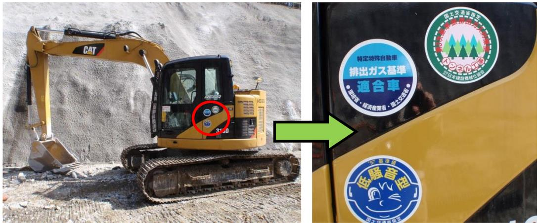
低騒音・低振動・排出ガス対策型建設機械の採用
