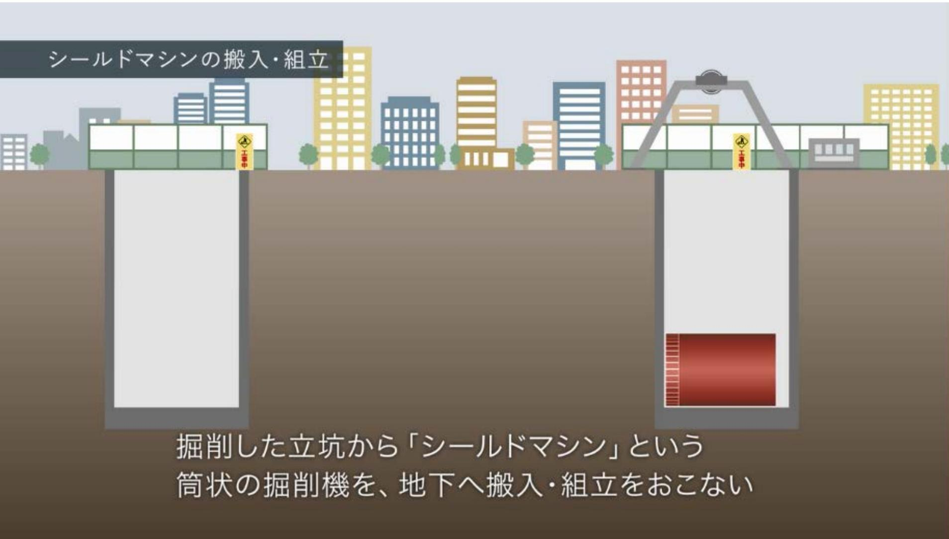
掘削した立坑から「シールドマシン」という筒状の掘削機を、地下へ搬入・組立をおこない
