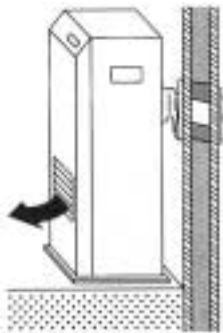
給排気筒 対象製品には屋外に給排気筒が設置されています。
