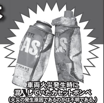
車両火災発生時に混入していたカセットボンベ
