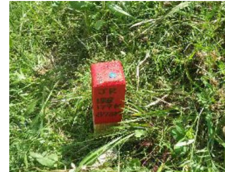
中心杭設置例 (杭)
