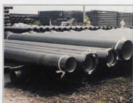
下水道用ダクタイル鋳鉄管
