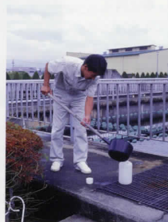
最終沈殿池での採水風景：この後減菌池に送られて放流されます。
