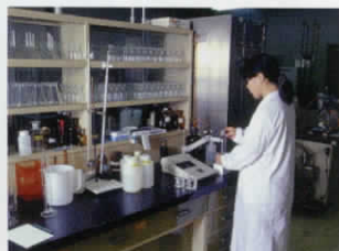
試験室では、定期的に各ブロックの水質検査を行っています。
