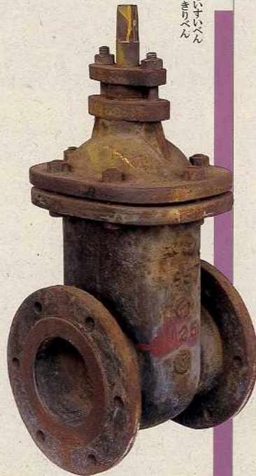
この125径の弁は、今は製造されていません。現在は75・100・150径のものが使われています。
