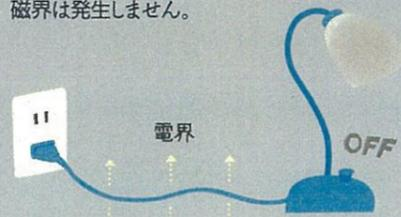
電気スタンドのスイッチを入れると、電流が流れ、コードのまわりには電界と磁界の両方が発生します。
