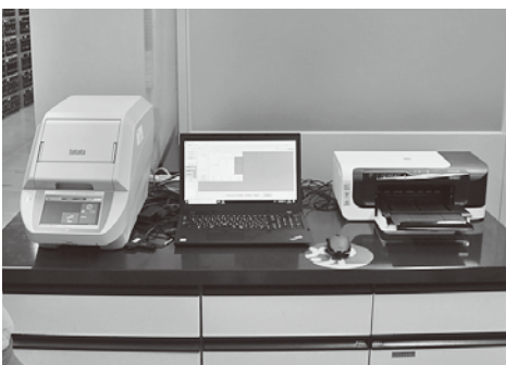
▲新型コロナウイルスの遺伝子配列の存在を検出するための「PCR検査装置」
