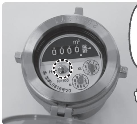
水を出していないのに羽根車が回転していれば、漏水の可能性がります。
