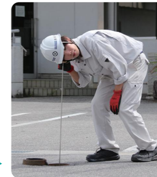
漏水音を聞き分ける機器(音聴棒)
