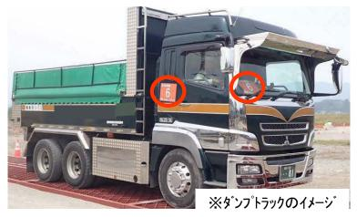
・ダンプトラックは 左右各1枚、前後各1枚 計4枚設置
