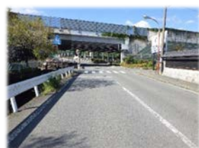
(通学路の横断歩道手前をカラー舗装し注意喚起を促した事例)
