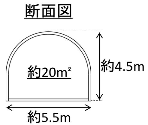
作業用トンネルは、施工ヤード（土曾川）から掘削機を基本として掘削を行い、発進坑に接続する予定です。シールド工事に伴う発生土搬出のために、作業用トンネル内にはベルトコンベアを設置する予定です。作業用トンネルは最終的には埋め戻す計画です。
