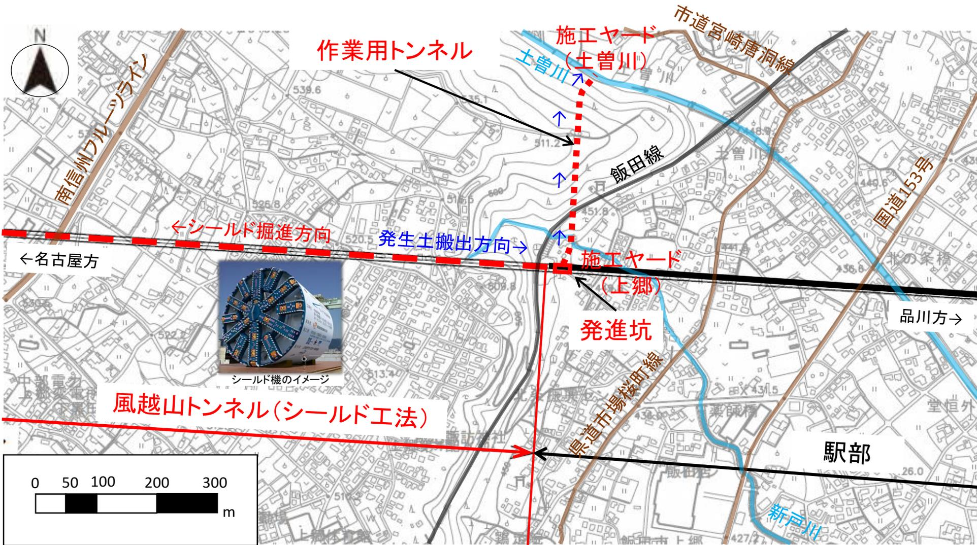
シールド工事に伴う発生土については、作業用トンネルを設け、施工ヤード（土曾川）へ搬出する計画です。
