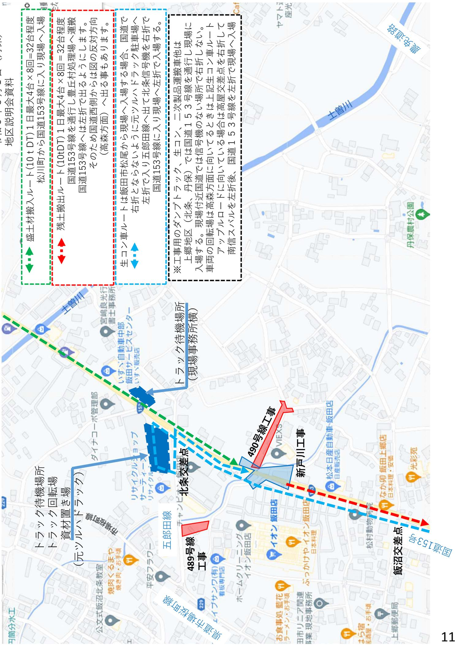
図5-② 工事用車両運行ルート（飯田市施工）
