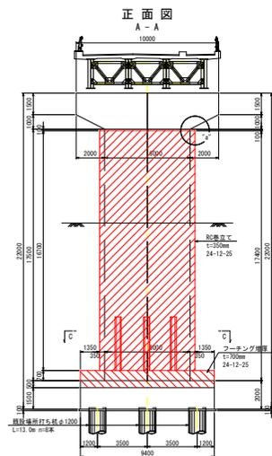
南大島川橋 P2橋脚(Fix)補強一般図
