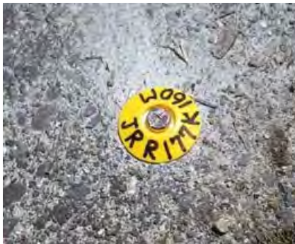
幅杭設置例 (鋳)
