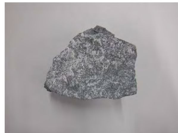
トンネル発生土(マイロナイト)
