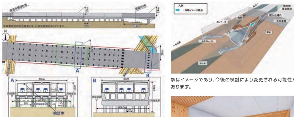
リニア駅の概要図は上から、リニア駅を南側から北側へ望む方向を横方向に見た高架橋の図、リニア駅区間に上から見た平面図、ホームA地点（駅舎中央）とB地点（国道153号付近）の2箇所の断面図となっています。平面図でAと囲まれた部分が、概ね駅舎の中央となる場所で、黄緑色で示された範囲が、飯田市で活用を予定している高架下空間となります。
