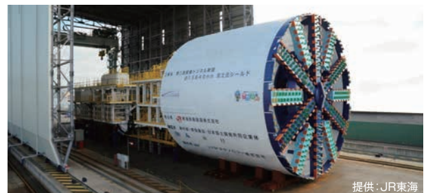
神奈川県でリニアのトンネル掘削を行うシールドマシン
