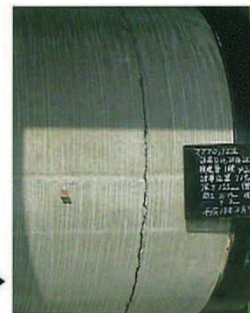
曲げ試験により誘導目地に沿って発生した外周部のクラック
