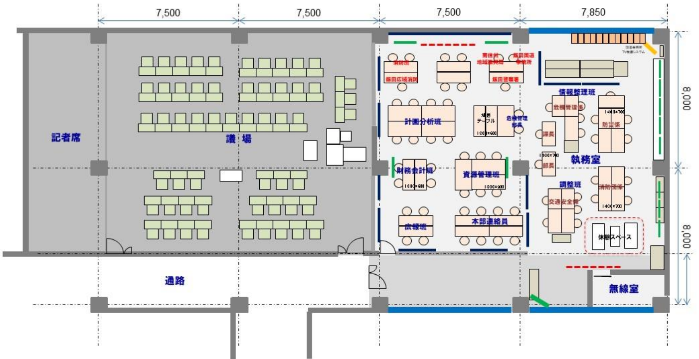
飯田市災害対策本部 オペレーションルーム 基本レイアウト ケース2:第一配備～第二配備態勢 (土砂災害警戒情報発表、土砂災害、降雪、震度5強～6弱)
