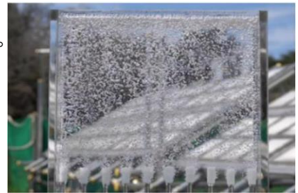
水素生成パネルによる水素発生の様子
