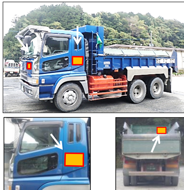
標識のダンプ明示状況イメージ ※左右各1枚、前後各1枚 計4枚設置
